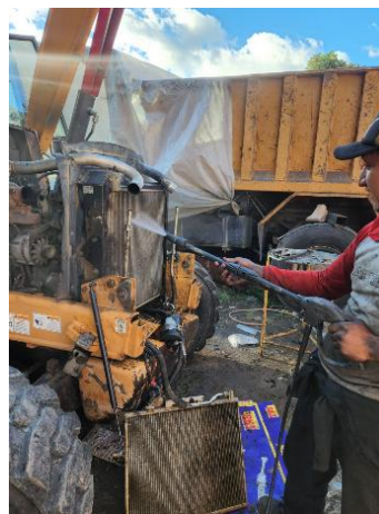
Limpieza del sistema de refrigeracion
